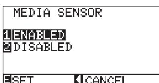
4 Нажмите кнопку [2] (Отключен, DISABLED) или кнопку [1] (Включен, ENABLED).
