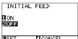
4 Активируйте режим предварительной подачи материала после его загрузки нажатием кнопки [1] (ON), или отключите его нажатием кнопки [2] (OFF).
