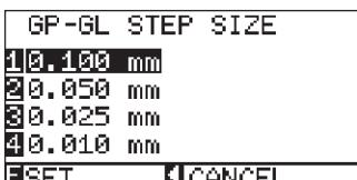
**4** Нажмите кнопку **[1]** (0.100 мм), кнопку **[2]** (0.050 мм), или кнопку **[3]** (0.025 мм), или кнопку **[4]** (0.010 мм).
