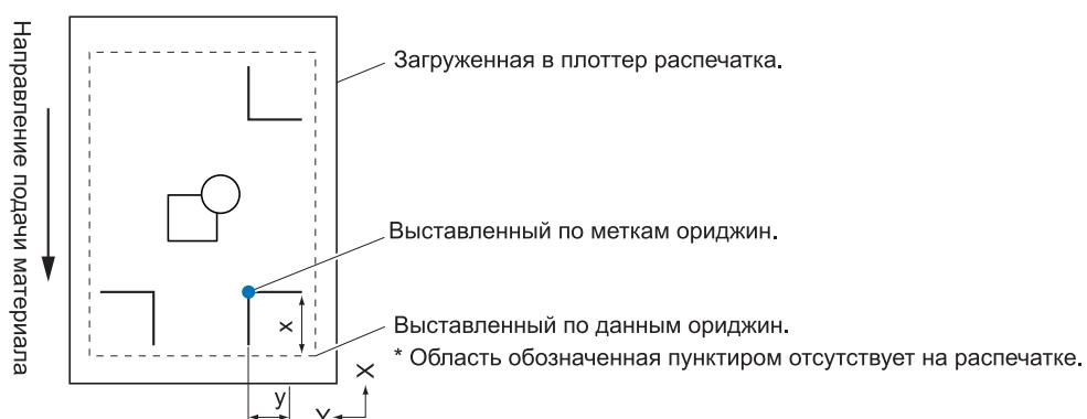
После считывания меток ориджин будет установлен в месте, показанном на картинке выше. Положение ориджина будет отличаться от положения заданного данными. Разница между этими двумя положениями называется оффсетом считывания. Задав оффсет считывания, вы можете расположить ориджин в любом удобном вам месте. Измерить оффсет считывания можно следующим образом.
