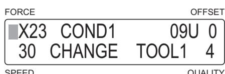
(3) Нажмите [ENTER] для отображения на дисплее параметров режима Thick (если для данного режима выбран еще и режим Thick).
