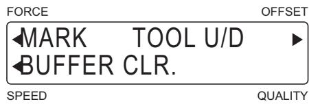
(3) Удерживая кнопку [F3], поднимите или опустите нож. Каждое нажатие [F3] поочередно поднимает, или опускает инструмент.
