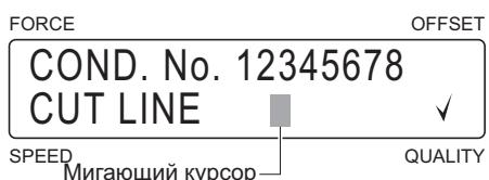
В верхнем ряду перечислены номера режимов резки. Галочкой отмечены те из них, для которых активирована перфорезка. Кнопками [ $\triangleleft$ ] и [ $\triangleright$ ] переместите курсор к номеру нужной группы и кнопками [ $\Delta$ ] и [ $\nabla$ ] активируйте для нее, или отключите, перфорезку.
