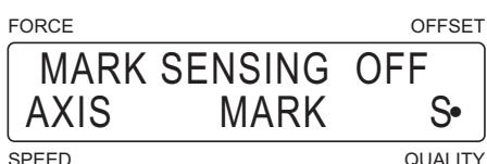
Текущий режим считывания обозначен меткой [●].
