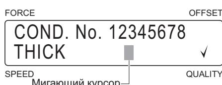
В верхнем ряду перечислены номера режимов резки. Галочкой отмечены те из них, для которых режим Thick активирован. Кнопками [ $\triangleleft$ ] и [ $\triangleright$ ] переместите курсор к номеру нужного режима и кнопками [ $\triangleup$ ] и [ $\triangledown$ ] активируйте для него, или отключите режим Thick. Подтвердите установки нажатием кнопки [ $\downarrow$ ] [ENTER].
