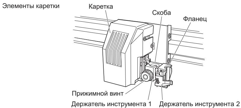
(1) Ослабьте прижимной винт держателя инструмента, чтобы вставить плунжер до упора во фланец.
