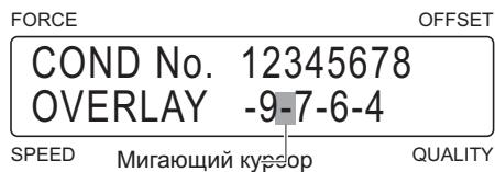
В верхнем ряду перечислены номера режимов резки. В нижнем ряду цифрой обозначено количество повторных резок для каждого режима.
