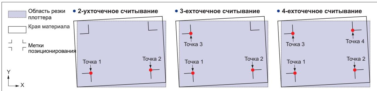
**2-ухточечное позиционирование:** плоттер считывает 2 метки, располагающиеся на оси X, и затем корректирует угол наклона этой оси.
