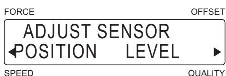
(7) Нажмите [F4] для входа в меню корректировки чувствительности датчика меток позиционирования.
