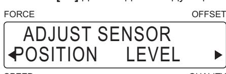
(7) Нажмите [F4] для входа в меню регулировки чувствительности датчиков меток позиционирования.
