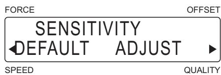
(10) Для ручной корректировки чувствительности датчика нажмите [F4] на экране появится следующее сообщение:
